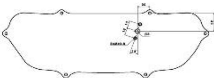
Posizione del sensore di temperatura
